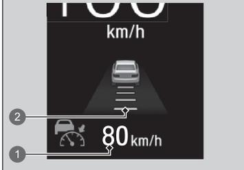
Bei aktivierter ACC mit Stauassistent werden im Instrument das Fahrzeugsymbol, die Abstandsbalken und die eingestellte Geschwindigkeit angezeigt.
