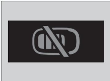
Wenn der Betriebsmodus auf einen anderen Modus als AUS gestellt ist und Sie die schlüssellose Fernbedienung aus dem Fahrzeug entfernen und die Tür schließen, ertönt ein Alarm. Wenn der Alarm weiterhin ertönt, bringen Sie die schlüssellose Fernbedienung an einen anderen Ort.
